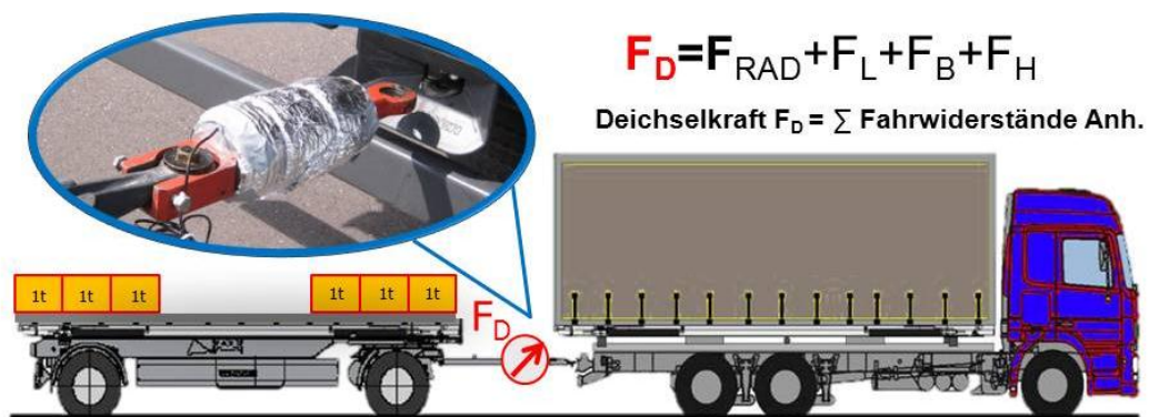
Abbildung 3.1: Koppelkraftmessung als Fahrwiderstandsindikator des Anhängers
