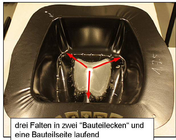
Abbildung 54: Faltungsbild beim quasistatischen Beulen stilisierter Federbeindomgeometrien
