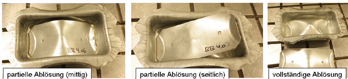
Abbildung 59: Versagensarten beim quasistatischen Beulen eines warmgeformten Rechtecknapfs
