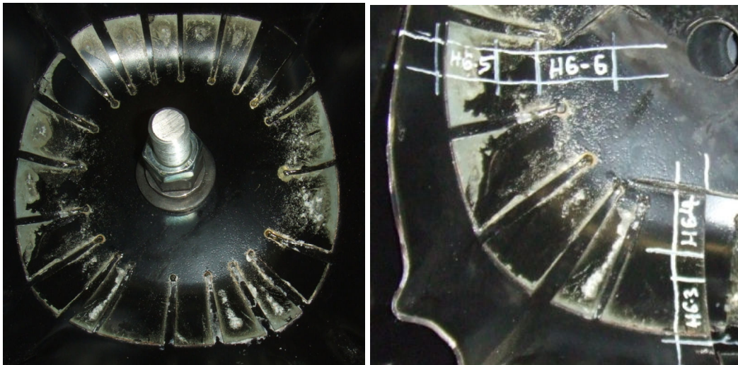
Abbildung 78: Probenahme aus einem beschleunigt gealterten Tiefziehnapf im verstärkten Bodenbereich (HBB 3.06, GB H340, VB TRIP 800, Vestamelt X1333, KTL, VDA modif. 10 Wochen, zyklisch getestet auf \pm 3 kN-Horizont)
