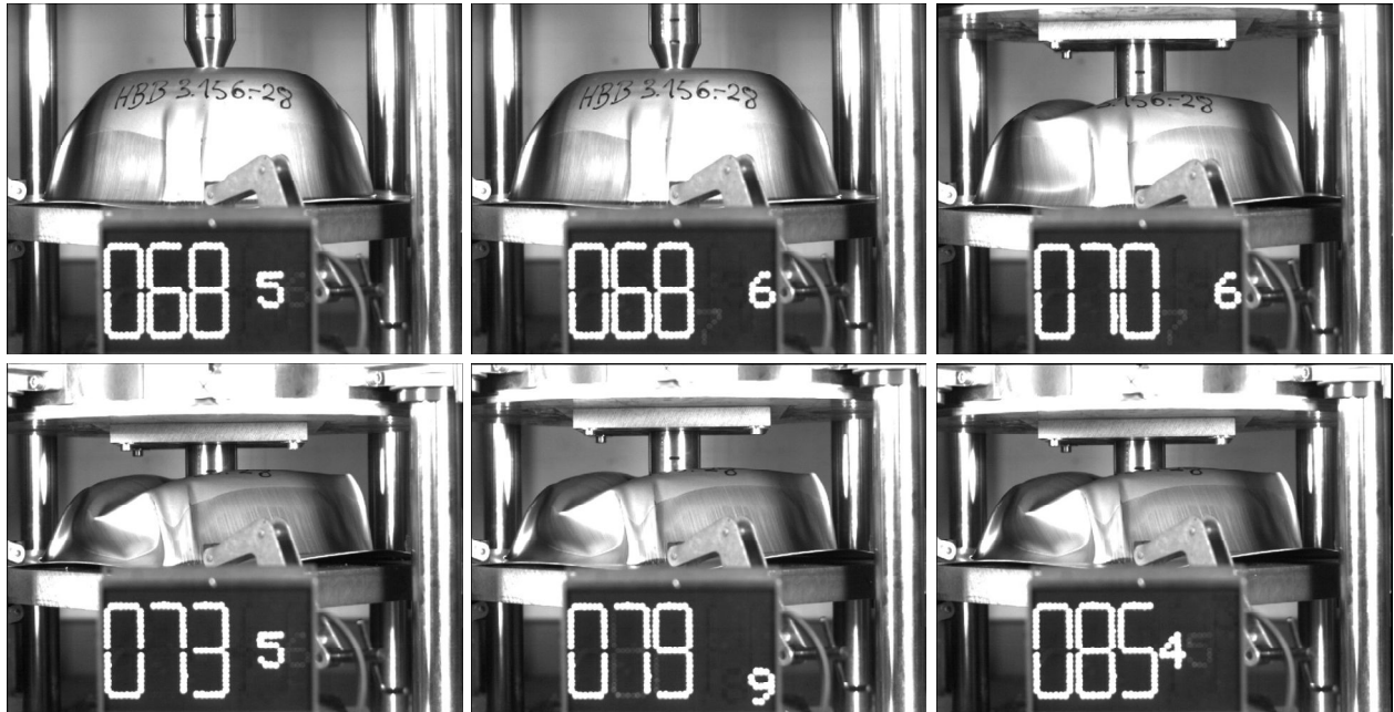
Abbildung 67: Phasen des Einschlags und der Probekörperreaktion beim 3-Faltenbeulen (Probe HBB 3.156)
