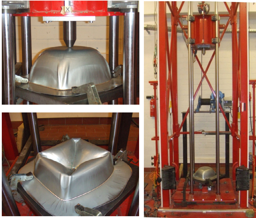
Abbildung 64: Fallturm für Crashversuche mit den Federbeindomgeometrien, einheitliche Prüfmass von 190 kg und Fallhöhe bis zum Auftreffen der Dornkuppe auf den verstärkten Bauteilboden von 1,5 m
