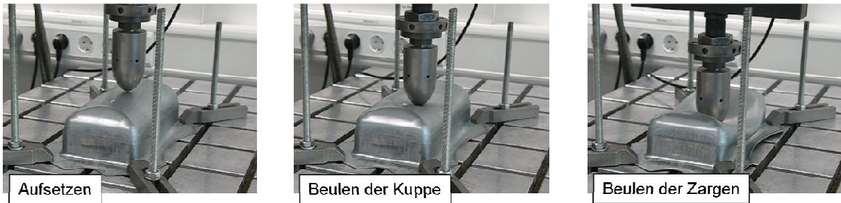
Abbildung 58: Prozessabfolge beim quasistatischen Beulen eines warmgeformten Rechtecknapfs
