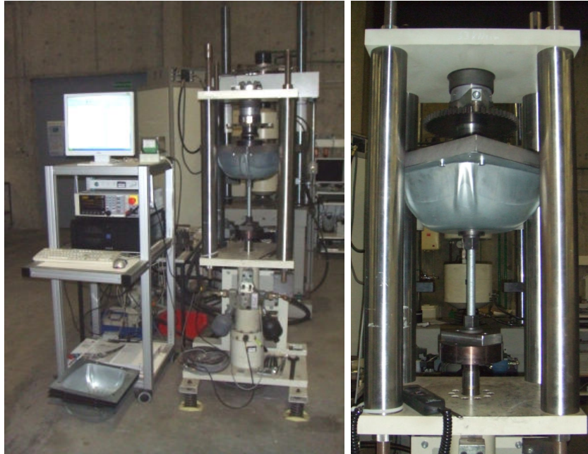
Abbildung 83: Hydro Bonded Blanks Bauteile im zyklischen Test im Prüffeld des ifs, Konfiguration mit Kraftmessdose und Aufnahmeplatte oben sowie Hydropulser mit Lasteinleitungsstange von unten in den Bauteilboden
