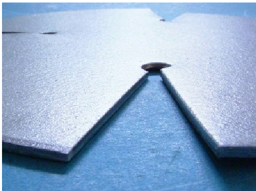
Abbildung 32: Methoden zur einfachen Beschichtung der Verstärkungsblechkanten mit Klebstoff zur Einbettung der Kante in die Klebschicht während des Tiefziehvorgangs, links angeschmolzener Pulverklebstoff, rechts an den VB-Kanten um wenige Millimeter überstehende Folien
