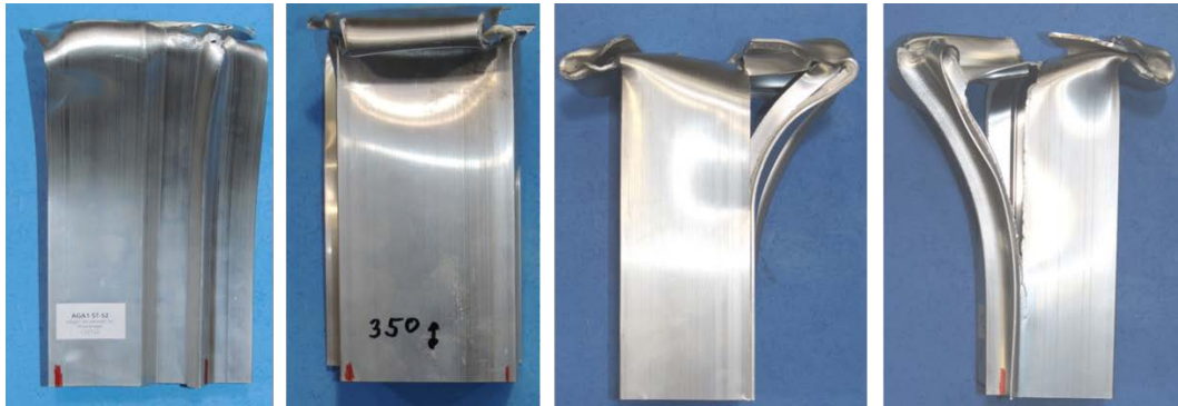
Abbildung 5-4: Fotos von vier Seiten des gestauchten Profils ohne Abschrägung
