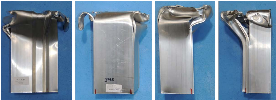
Abbildung 5-2: Fotos von vier Seiten des gestauchten Profils mit Abschrägung um 5° am oberen Ende
