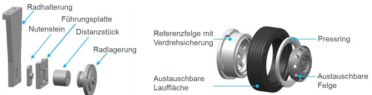
Abbildung 4.6 Konstruktive Detailansicht der Radaufhängung (links) und des Vorderrades (rechts)
