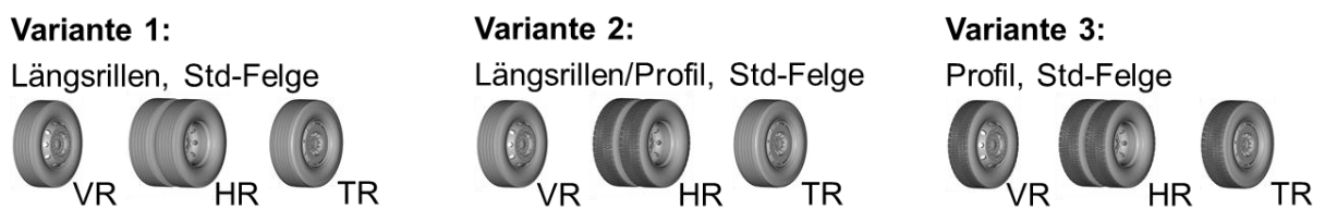
Abbildung 6.5 Übersicht vordefinierter Radkonfigurationen am Nutzfahrzeug in Abhängigkeit der Bereifungsart
