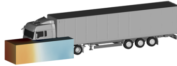
Abbildung 6.2 Schritte zur Durchführung einer Teilsimulation an der Vorderachse (VA) anhand der „Transient Boundary Seeding“-Vorgehensweise
