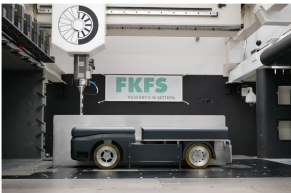
Abbildung 5.1 Windkanalversuche, links: Fahrzeugmodell auf der Messtrecke, rechts: Skizze zur Darstellung der Kraftaufnahme über die Waage
