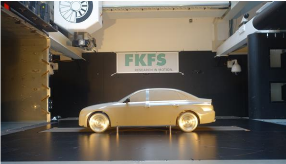
Abbildung 2.2 Modellwindkanal der Universität Stuttgart, links: Messstrecke, rechts: Detailansicht des 5-Band-Systems in Anlehnung an [9]
