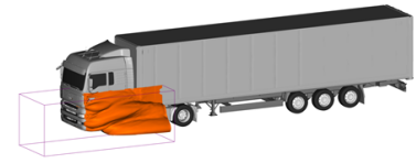
Abbildung 6.2 Schritte zur Durchführung einer Teilsimulation an der Vorderachse (VA) anhand der „Transient Boundary Seeding“-Vorgehensweise
