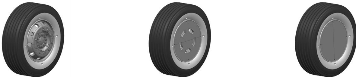
Abbildung 4.8 Felgenaufsätze am Vorderrad, links: Standardfelge, mitte: Eco-Felge, rechts: geschlossene Felge
