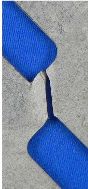
Scherzone nach Bruch YS2-Sz0°-S1Q quasistatisch
