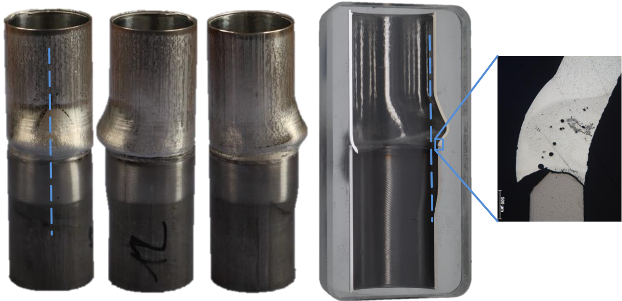
Abbildung 42: Innenhochdruckumgeformte Probe aus Versuch 12, oben EN AW-6082, unten: E235+C, Umformparameter: Druck 700 bar, Prozesszeit 7 s, Gegenhalter in äußerster Position, Stempelnachschub je 3 mm; links: Ansicht aus drei Richtungen, mittig: Querschliff der gleichen Probe, blaue Linie markiert die ursprüngliche Geometrie, rechts: vergrößerte Aufnahme der umgeformten Lötnaht
