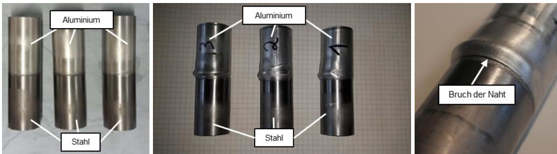
Abbildung 40: THTs aus E 235+C und EN-AW 6060 vor (links) und nach dem Umformvorgang (mittig) und Bruchbereich der umgeformten Probe 1 (rechts)
