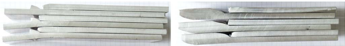
ABBILDUNG 5.21: BRUCHSTELLEN EINFACH ÜBERLAPPTER SCHERZUGPROBEN AUS ALUMINIUM
