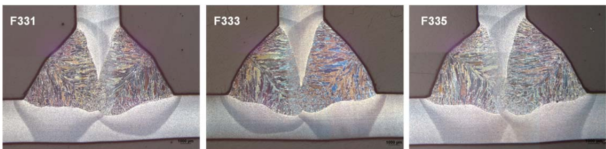
ABBILDUNG 4-33: SCHLIFFBILDER DER NÄHTE EINES BEIDSEITIG GESCHWEISSTEN T-STOSSES
