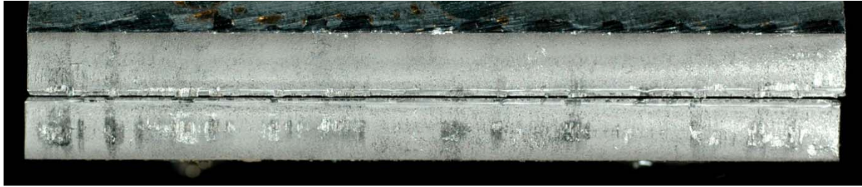
ABBILDUNG 5-29: BRUCHBILD - F252 (R=0, BEIDSEITIG GESCHWEISST, NAHTÜBERGANG)
