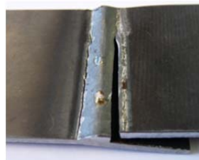
ABBILDUNG 5.25: ANRISSORTE BEI EINFACH ÜBERLAPPTEN SCHERZUGPROBEN AUS STAHL (EINSEITIG GESCHWEISST)
