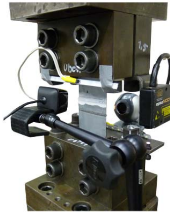
ABBILDUNG 5.1: EINSpannung einfach überlappte Scherzugproben
