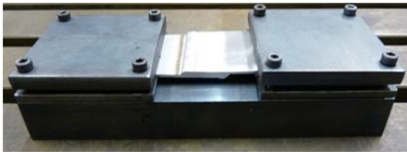
ABBILDUNG 5.20: VORRICHTUNG ZUM THERMO-MECHANISCHEN RICHTEN (LINKS) UND WINKELVERZUG VOR UND NACH DEM RICHTEN (RECHTS)
