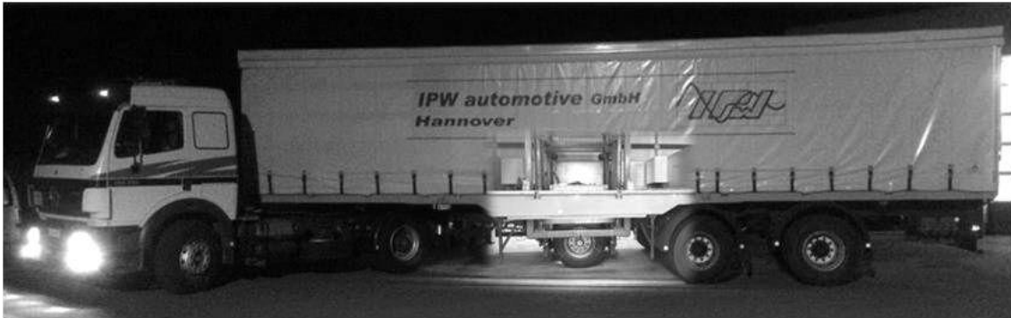
Abbildung 4.10: Spezialmessfahrzeug „Mobile Tire Lab“, [3]
