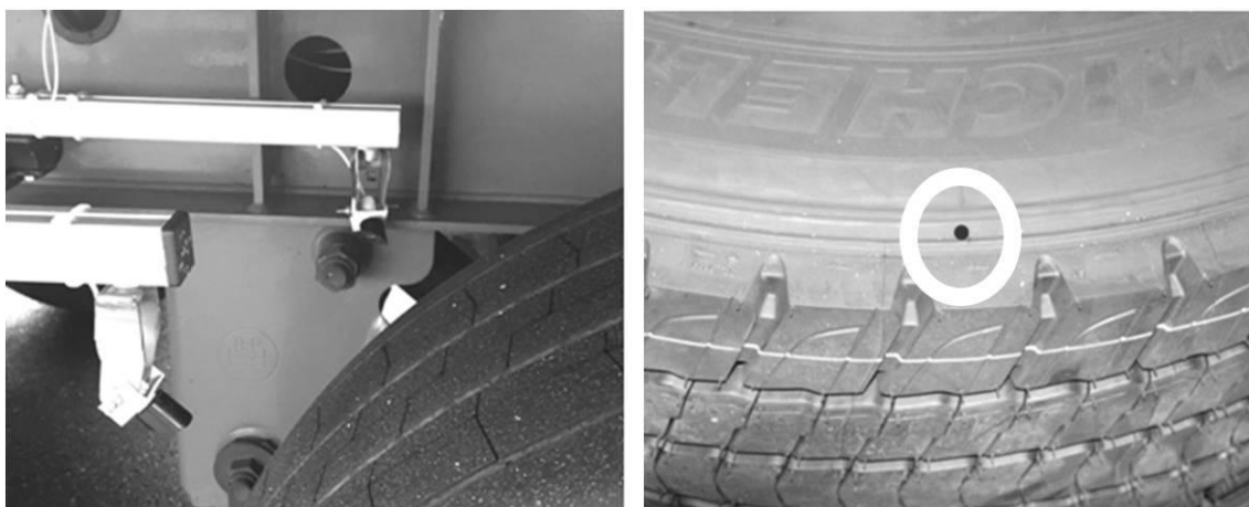
Abbildung 4.1: Einbausituation der Infrarotsensoren für Reifenlauffläche und Reifenschulter am Beispiel eines Trailerachsreifens (links). Visualisierung von Position und Größe des Messflecks auf der Reifenschulter (rechts).
