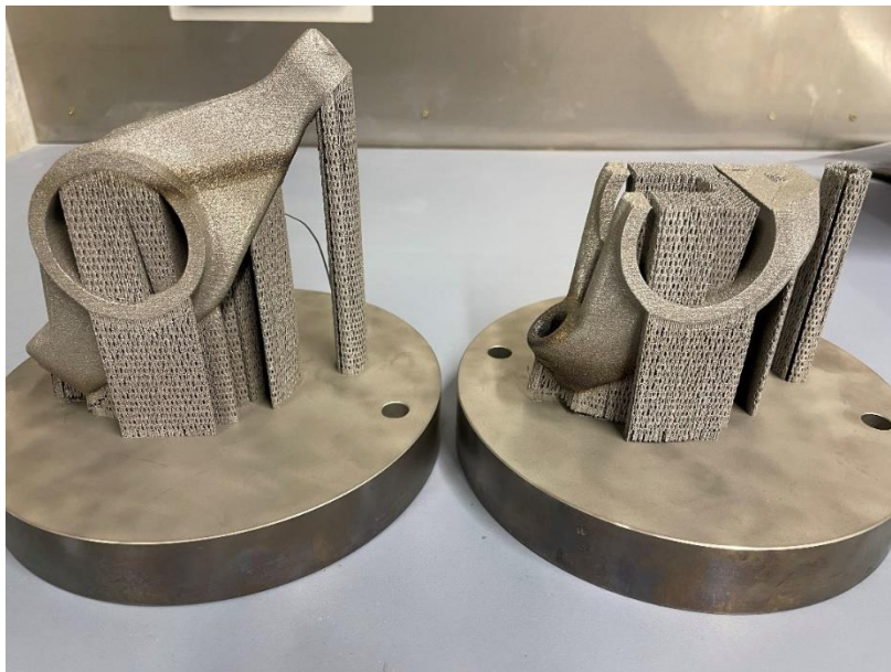
Abbildung 35: links: unterbrochener Fertigungsprozess fortgesetzt. Rechts: abgebrochener Fertigungsprozess.
