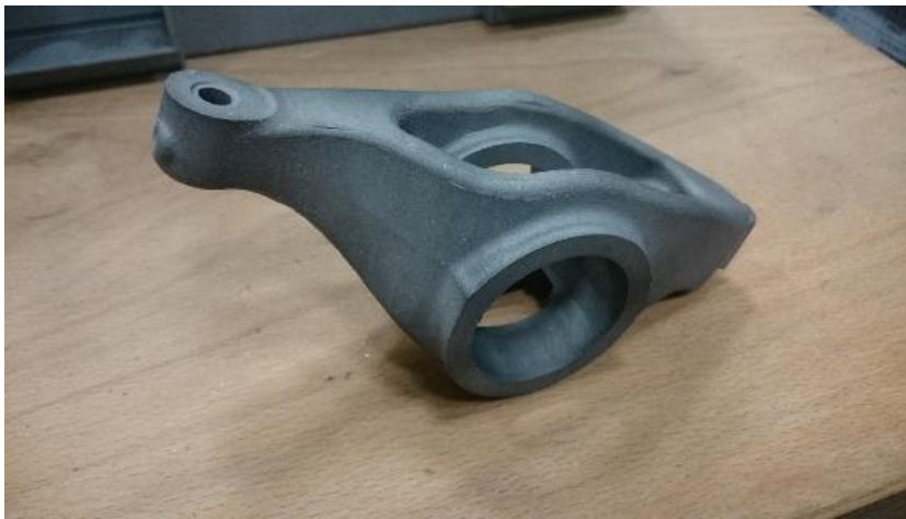
Abbildung 2: Motorkipphebel von MAN Truck & Bus SE als Demonstrator des Projektes
