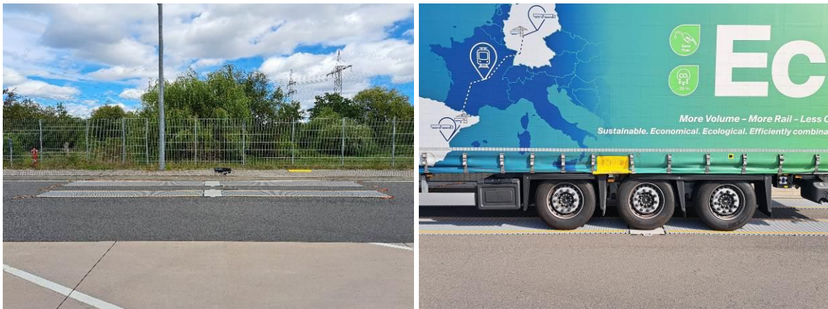
Abbildung 6 – Ermittlung der statischen Achslasten
