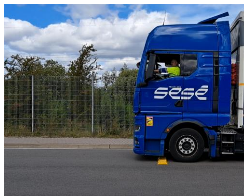
Abbildung 10 – Überfahren der Normschwelle
