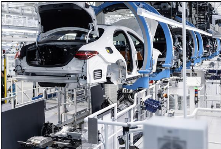
Bild: Flexible Hochzeit – ein klassischer Arbeitsschritt in der Montage neu gedacht. Fullflex Marriage in der Factory 56 der Mercedes-Benz AG in Sindelfingen (Quelle: Mercedes-Benz AG)
