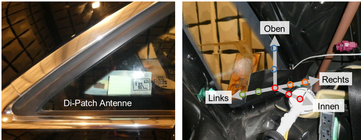
Abbildung 3.18 links – Außenansicht mit Di-Patch im Einbauzustand am hinteren Seitenfenster. rechts - Innenansicht mit Feldsonde und Messpunkten im 5 cm Raster um den Einbaupunkt.
