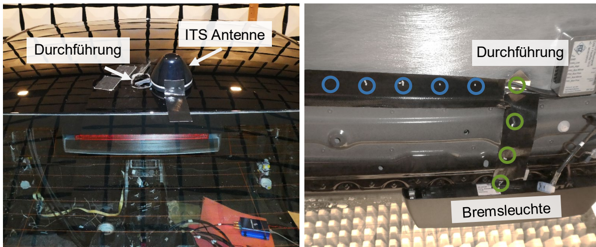
Abbildung 3.20 links – Außenansicht mit der Heckscheibe mit montierter Magnetfußantenne auf dem Fahrzeugdach. Die Antenne ist mit der OBU im Fahrzeuginneren verbunden. rechts - Innenansicht mit Messpunkten im 5 cm Raster um die Dachdurchführung.
