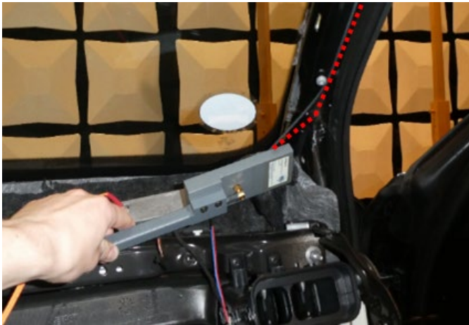
Abbildung 3.44 Beispiel für Test mit Breitbandantenne UWB2-6 des FTZ direkt auf Leitungen
