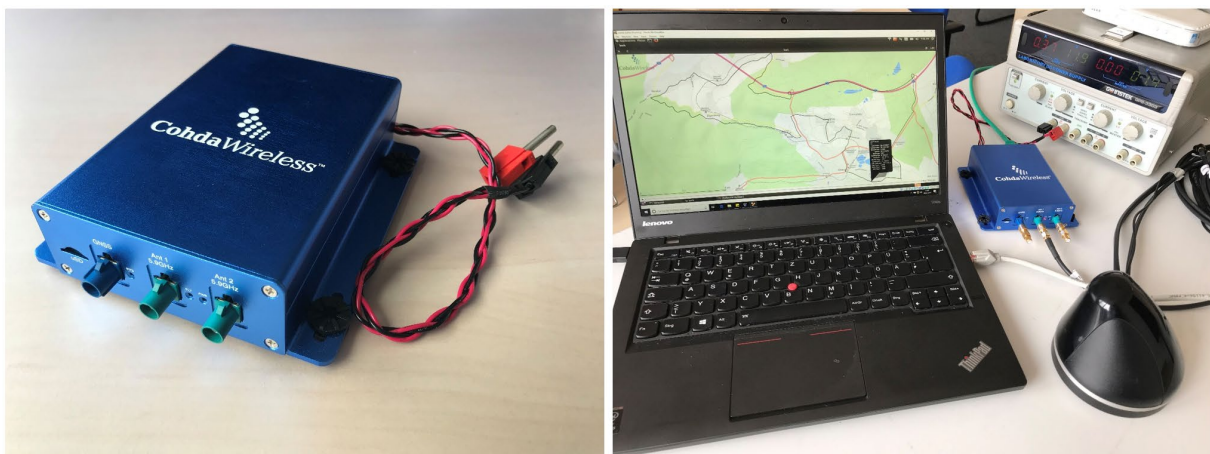
Abbildung 3.1: ITS-G5-System OBU MK5 von Cohda Wireless (links) und ITS-G5-Systemaufbau: PC mit Software für Simulation der Straßenrundfahrt und angeschlossener OBU mit Kfz-Dachantenne (rechts)
