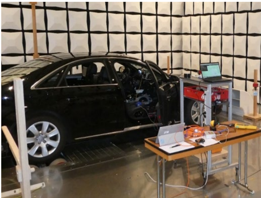
Abbildung 3.9 Messaufbau mit Testfahrzeug (Audi A8) in der Absorberhalle des FTZ in Zwickau
