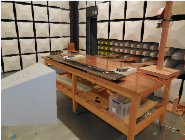
Abbildung 3.37 Beispiel für Messaufbau, Anordnung mit Prüfantenne BBHA 9120J auf DUT ausgerichtet
