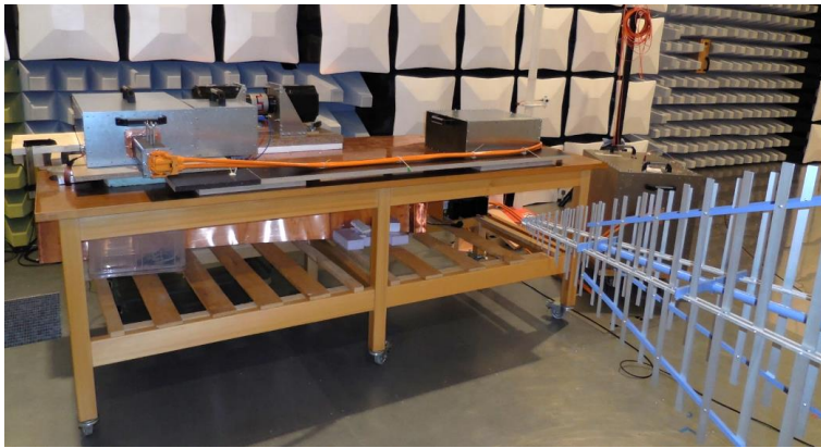
Abbildung 89 Messaufbau mit Antriebsmotor und Belastungs-maschine mit Umrichter als DUT
