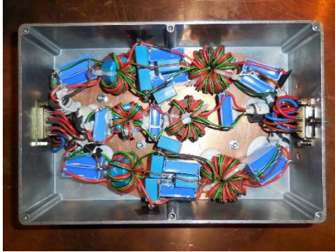
Abbildung 44 Aufbau eines Filters für die Niedervoltanschlüsse des Umrichters
