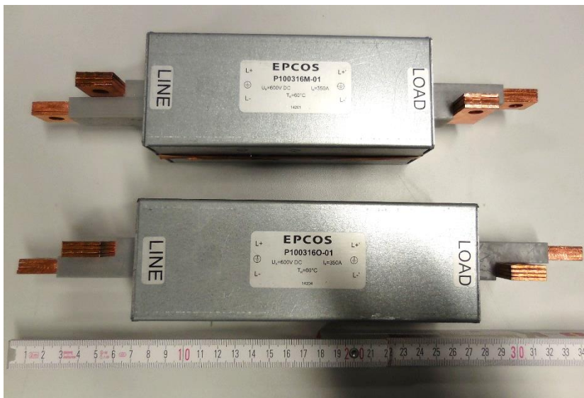
Abbildung 66 zwei 350 A DC-Filter der Serie P100316 mit Maßen
