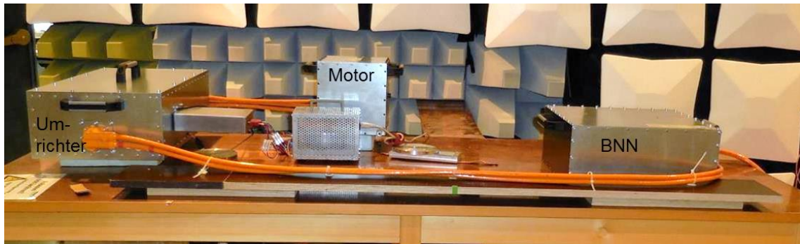
Abbildung 48 Messaufbau auf Komponentenmesstisch mit Umrichter als DUT
