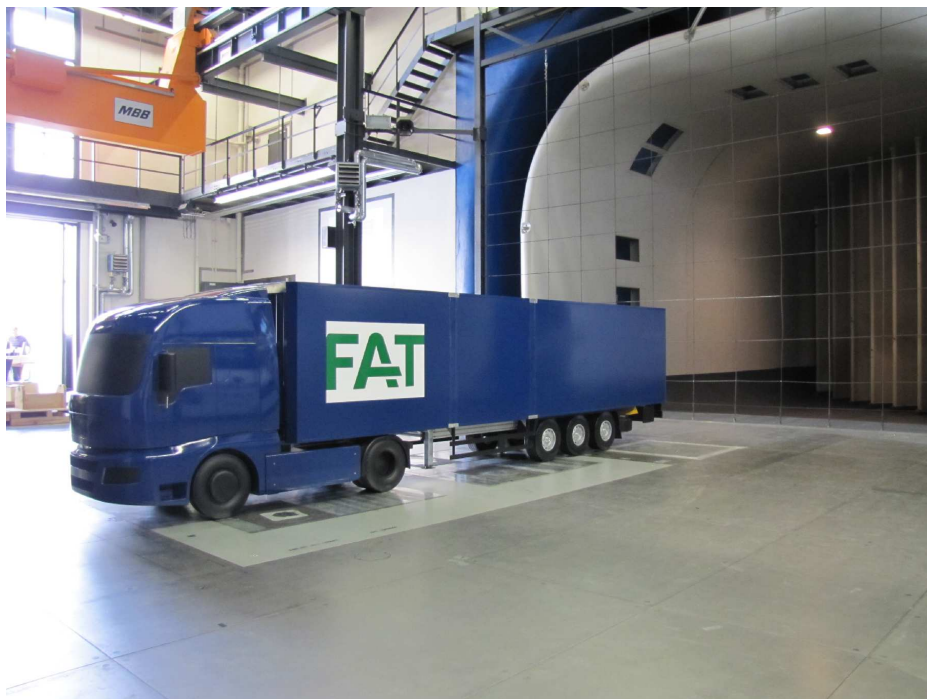
Abbildung 5.4: Verlängerung der gesamten Stirnseite. Experimentelle Front- und Dachmodule
