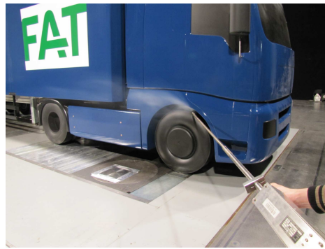
(a) Nachlauf am Vorderrad
