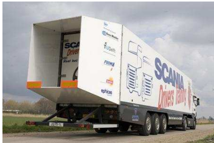
Abbildung 2.4: Beispiel eines „Boat-Tail“ Einzugs (Quelle: TU Delft)
