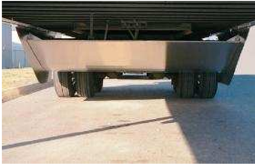
Abbildung 2.2: Airwedge der Firma Airman Inc., leitet die Luft unter den Trailerachsen hindurch; Quelle: Airman Inc.
