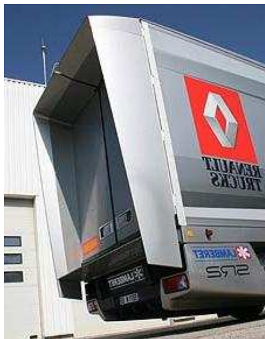
Abbildung 2.5: Heckeinzug am Renault Optifuel Lab, Quelle: Renault
