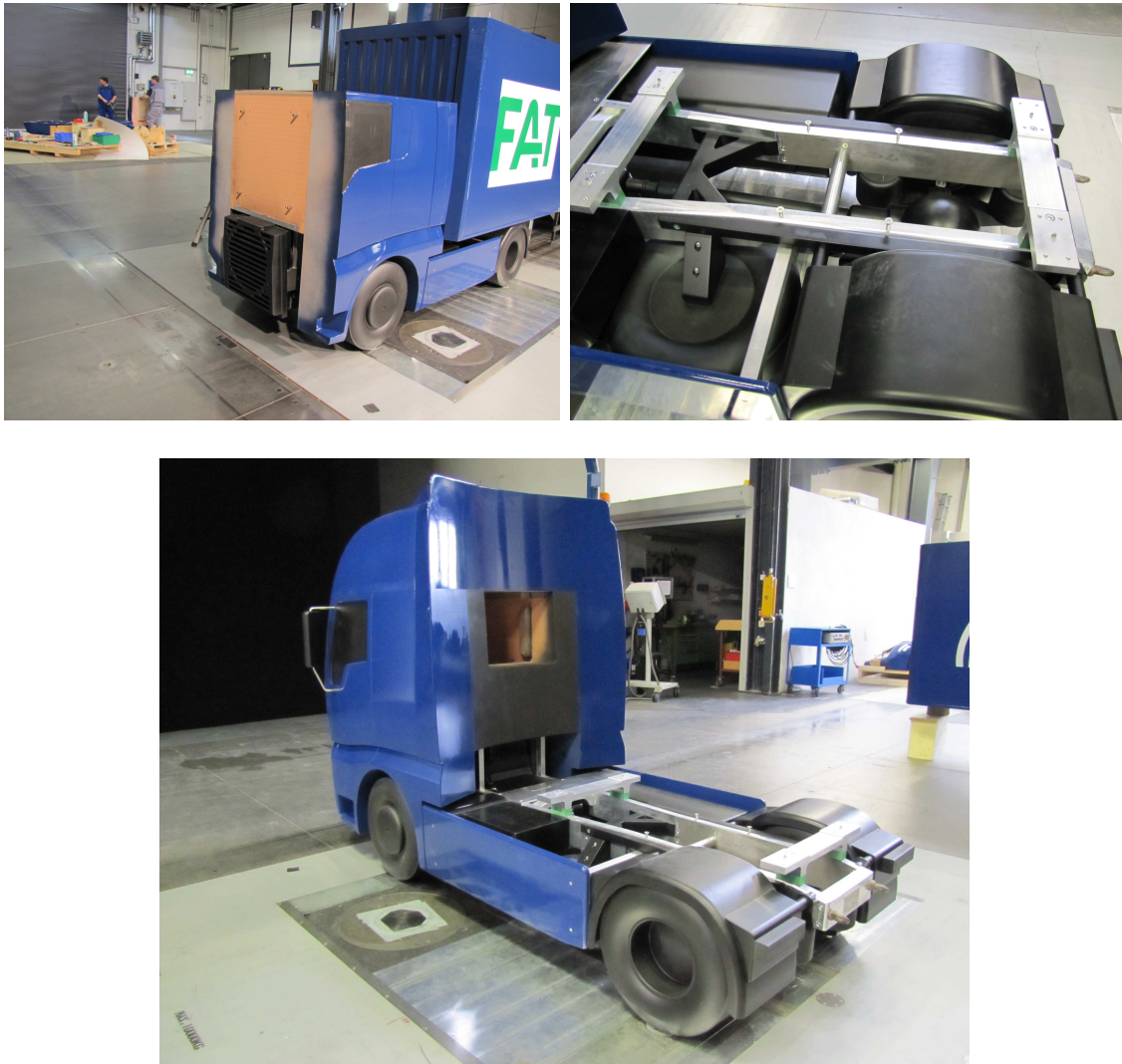
Abbildung 3.11: 1 : 2,5 skaliertes Windkanalmodell des generischen Fahrzeuges
