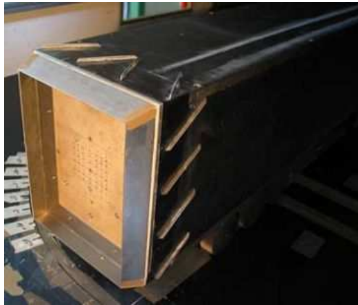
Abbildung 2.6: Wirbelgeneratoren am Heck eines Lkw-Modells, Institut für Strömungsmechanik und Technische Akustik an der TU Berlin
