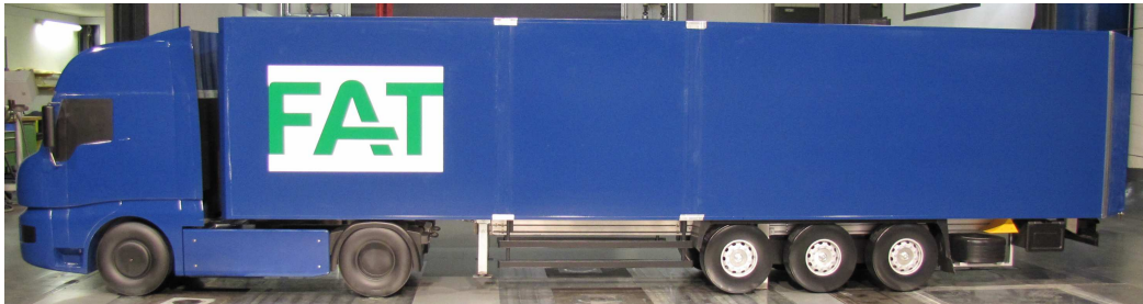
Abbildung 5.27: Beispiel einer Kombination Kurzhauber / Heckklappen
