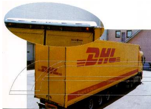
Abbildung 2.7: Dachspoiler für Auflieger; Quelle: http://www.sdr-sys.com/ing/?page_id=9
