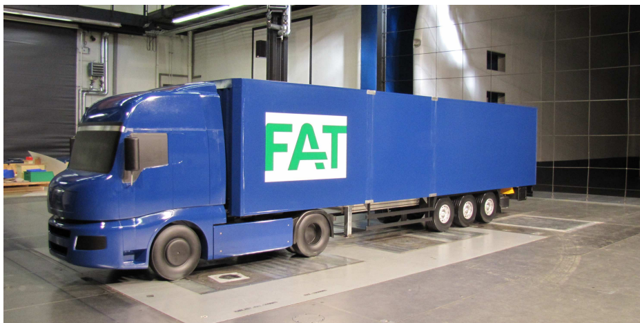
Abbildung 5.9: Kurzhauber. Experimentelles Frontmodule. Dach und Spiegel bleiben unverändert
