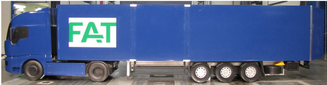
Abbildung 5.25: Beispiel einer Kombination Frontverlängerung / Heckklappen
