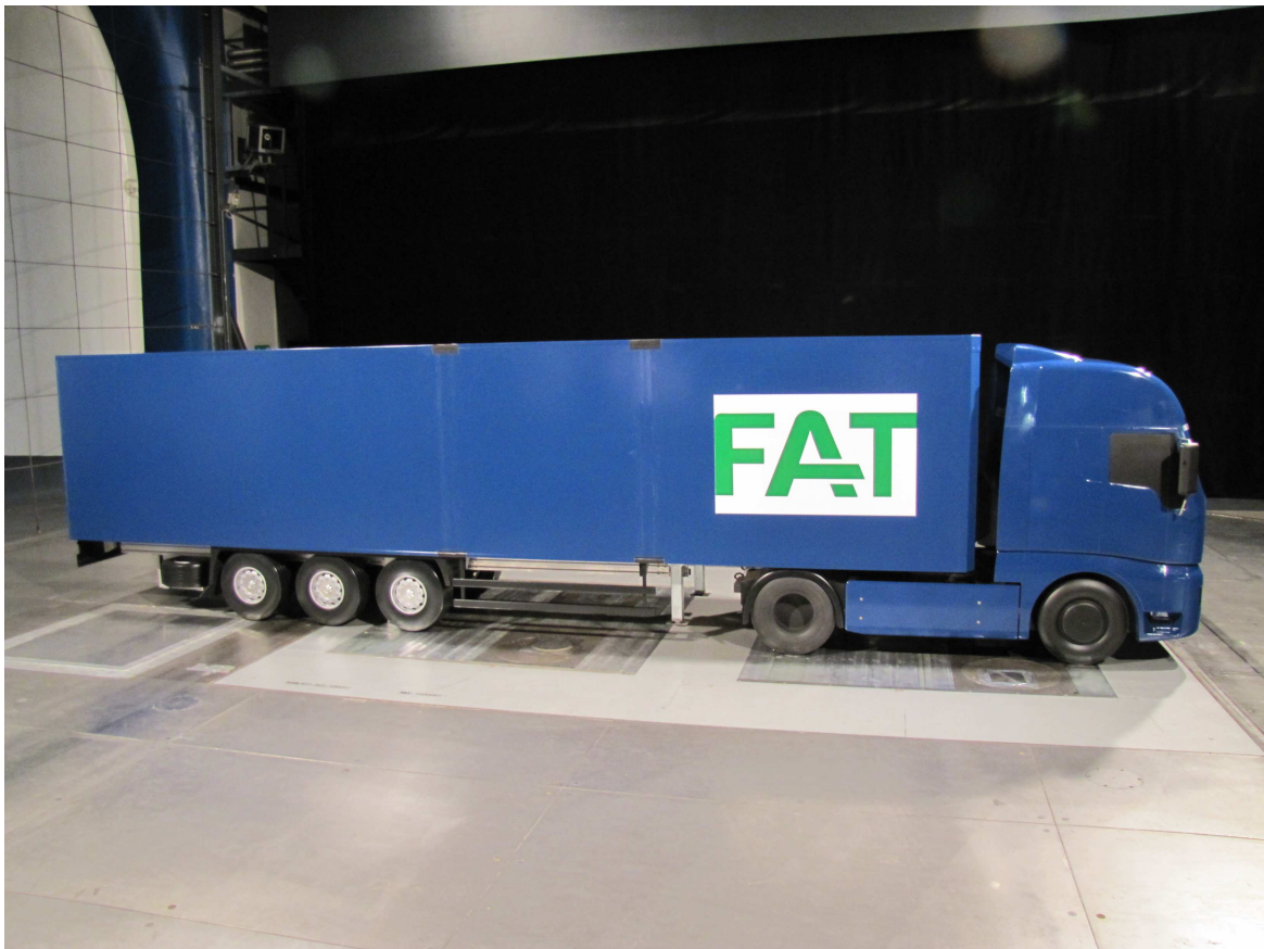
Abbildung 3.12: Gesamtbild des Windkanalmodells
