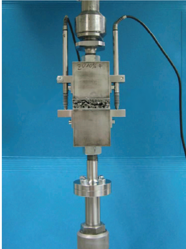
Abbildung 22: Spannvorrichtung für die Prüfung des Aluminiumschaumkerns senkrecht zur Deckschichtebene
