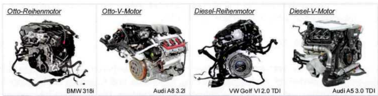
Abb. 6-46: Übersicht der verschiedenen Bauweisen der Otto- und Dieselmotoren
