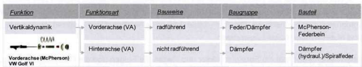
Abb. 4-13: Übersicht der Gliederung der Funktion Vertikaldynamik
