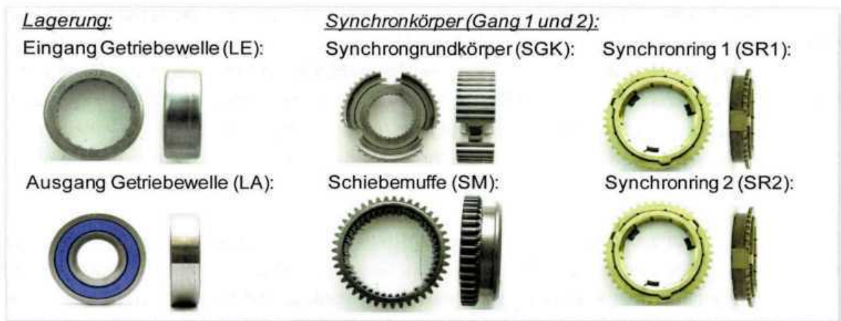
Abb. 6-59: Lagerung der Getriebewellen und Synchrongrundkörper des Opel Zafira
