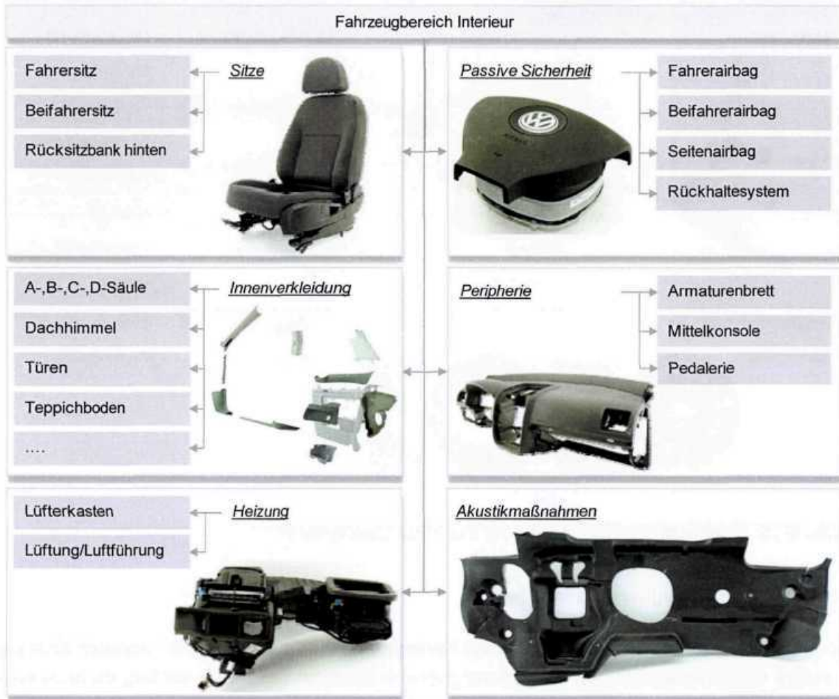
Abb. 4-16: Einteilung des Fahrzeugbereichs Interieur in Funktionen und Baugruppen
