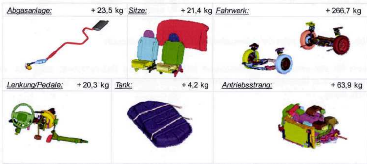
Abb. 6-21: Übersicht gewichtserhöhter Fahrzeugkomponenten (+ 400 kg)
