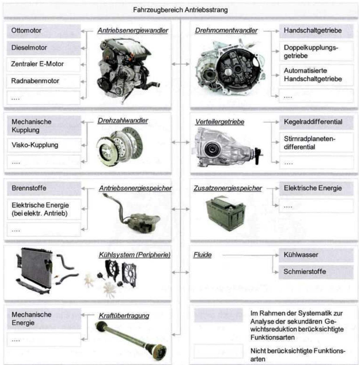
Abb. 4-5: Einteilung des Fahrzeugbereichs Antriebsstrang in Funktionen
