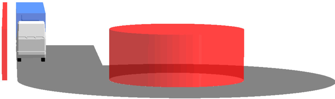
Abbildung 8.11: BOKraft-Kreis mit eingezeichneten Grenzflächen für maximales Ausschermaß und kleinsten Kreis, der von der Schleppkurve nicht geschnitten werden darf
