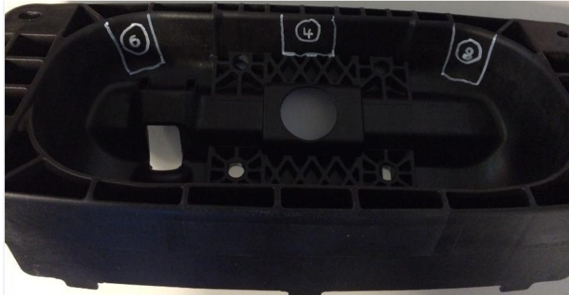
Bild 118: Position der Proben 4,6,8 zur Ermittlung der Faserkonzentrationen.
