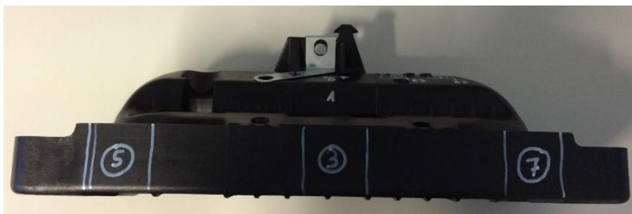
Bild 114: Position der Proben 3,5,7 zur Ermittlung der Faserkonzentrationen.
