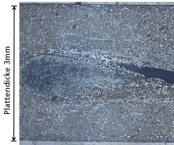
Bild 11: Schliffbild unter dem Lichtmikroskop des LFT-Werkstoffes mit 40 Gew.-% Glasfasergehalt. Häufig bilden sich die dargestellten Fasernester.
