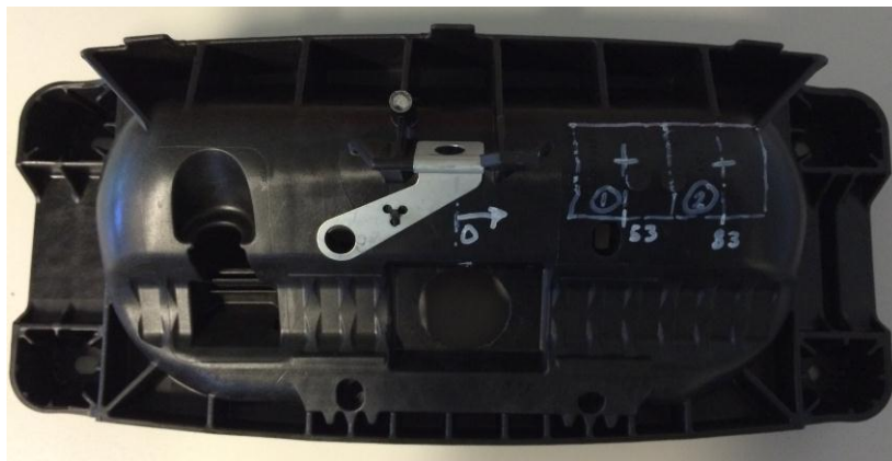
Bild 116: Position der Proben 1,2 zur Ermittlung der Faserkonzentrationen.
