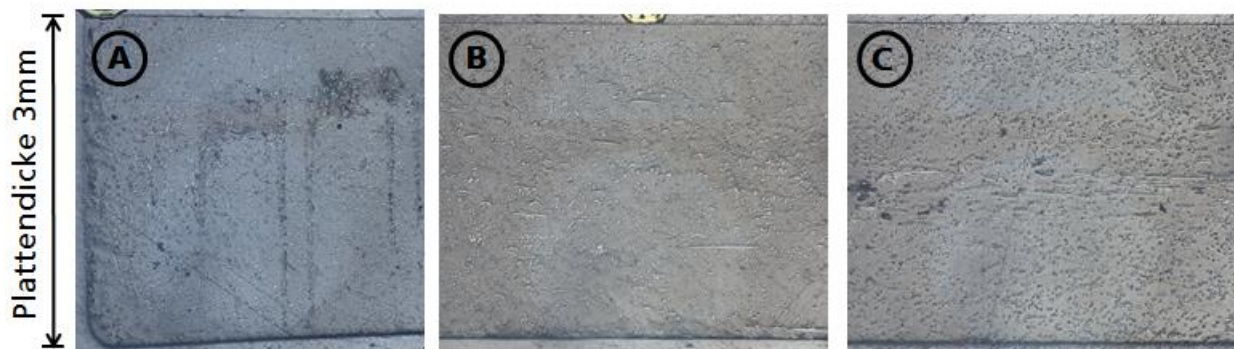
Bild 10: Schliffbilder unter dem Lichtmikroskop senkrecht zur Fließrichtung des LFT-Werkstoffes mit 30 Gew.-% Glasfasergehalt. A: Randbereich, B: 20mm Abstand vom Plattenrand, C: Plattenmitte
