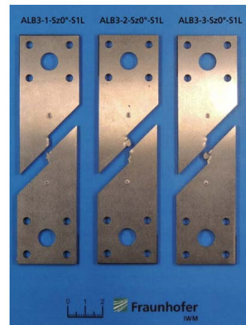
Abbildung 3-65: Scherzugproben nach Versuch, GJS-500-14
