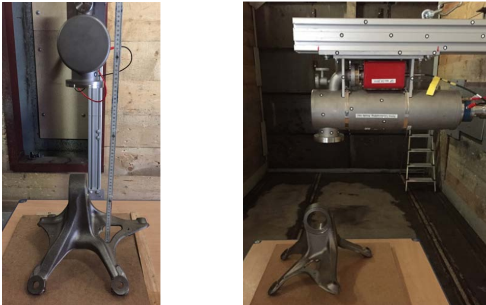
Abbildung 3-137: Röntgen einer Lagerkonsole am EMI
