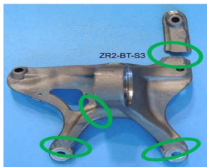
Abbildung 2-9: a) Schädigungsstellen in der Konsole nach statischem Versuch
