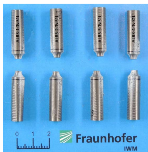
Abbildung 3-74: Torsionsproben nach Versuch, GJS-500-14
