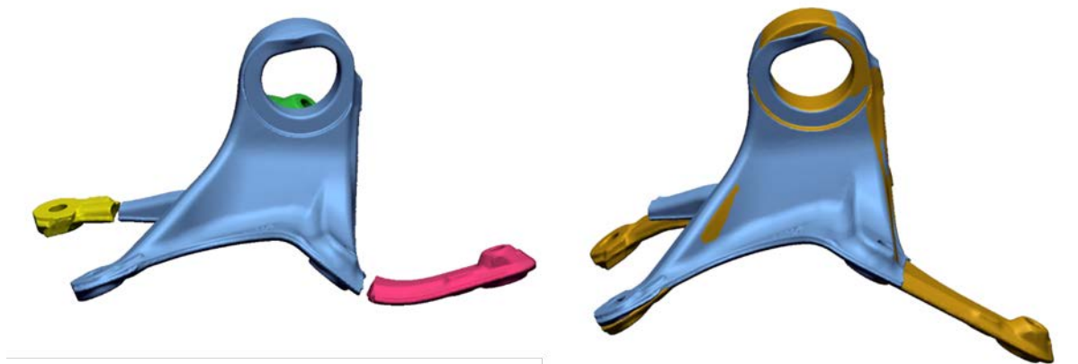
Abbildung 3-144: links: Kernstück (blau) der Lagerkonsole und Bruchstücke (farbig), rechts: Überlagerung der unbelasteten Komponente (braun) und des Kernstücks (blau)
