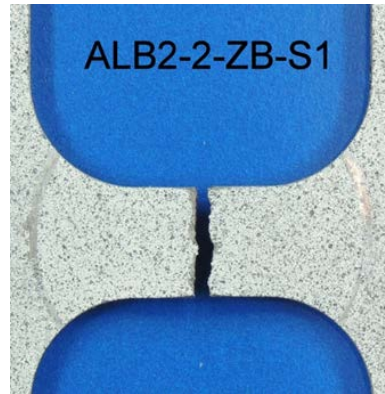
Abbildung 3-16: Eine Durchbiegeprobe aus GJS-450-18 nach Versuch
