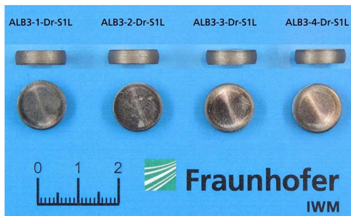
Abbildung 3-34: Druckproben nach Versuch, GJS-500-14
