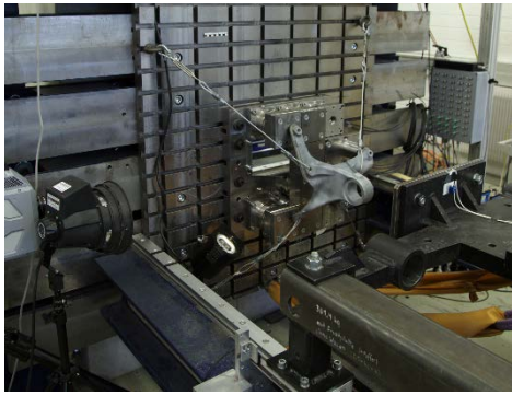
Abbildung 5-9: Aufbau dynamische Bauteilversuche
