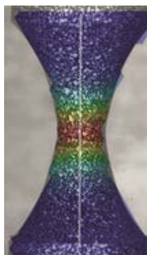
Abbildung 3-90: Optische Analyse des Dehnungsfeldes mittels der Software GOM Correlate
