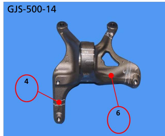
Abbildung 5-34: Entnahmepositionen für Rundzugproben aus Konsole von GJS-500-14
