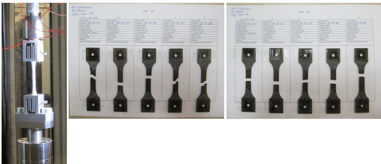
Abbildung 3-98: Versuchssetup auf VHS-Prüfmaschine, Proben nach der Prüfung
