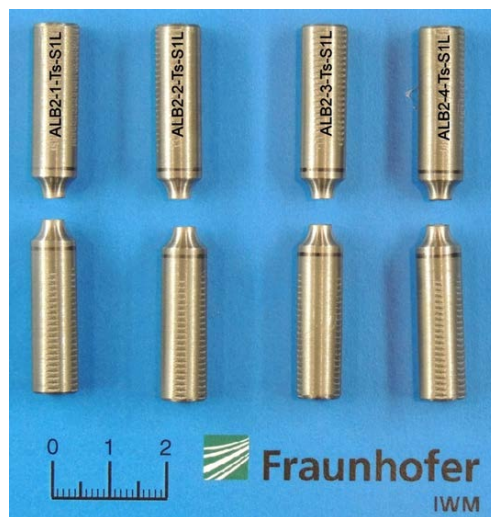
Abbildung 3-55: Torsionsproben nach Versuch, GJS-450-18
