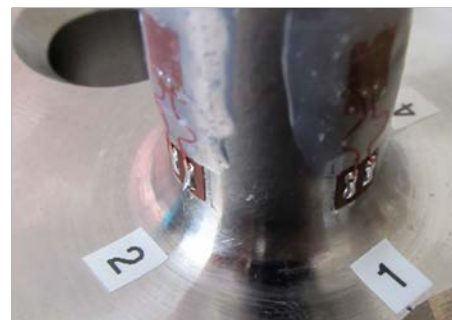
Abbildung 3-88: Konstruktion eines DMS-basierten Kraftmessadapters durch EMI; Applikation der DMS durch ESA-Messtechnik
