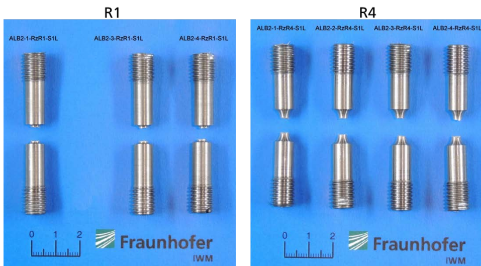
Abbildung 3-39: Rundkerbzugproben mit 2 Kerbradien nach Versuch, GJS-450-18
