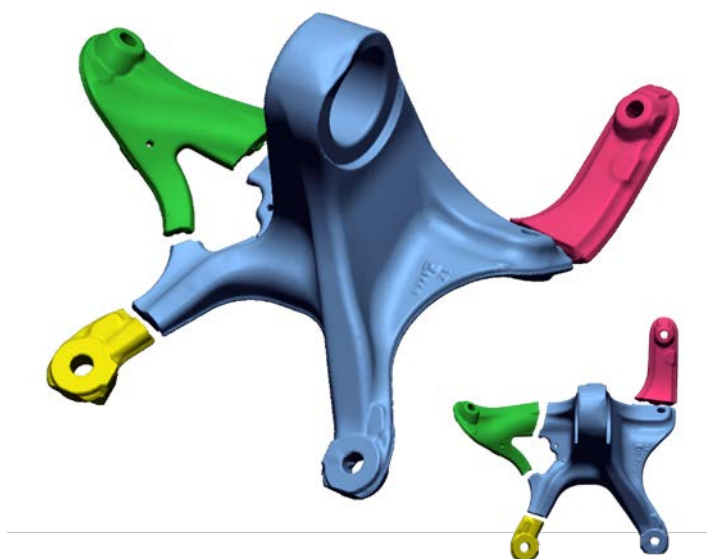
Abbildung 3-143: Kernstück (blau) der Lagerkonsole und Bruchstücke (farbig)
