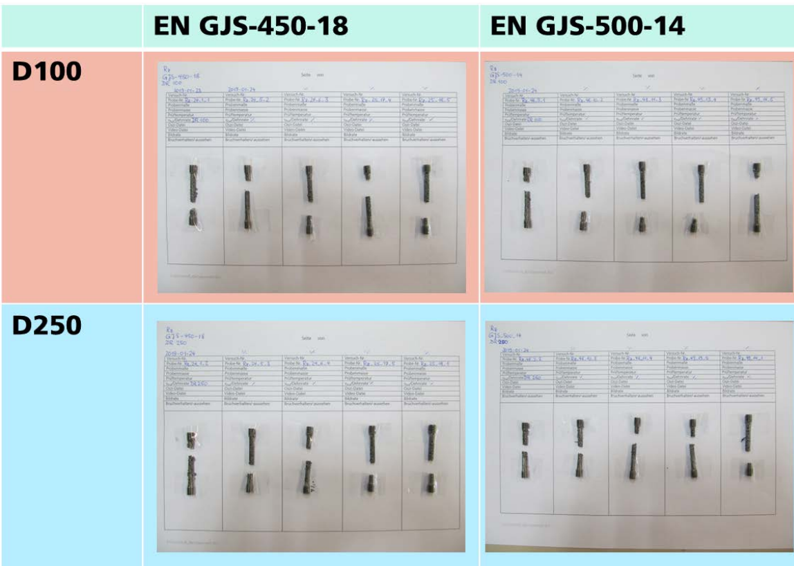
Abbildung 3-92: Rundzugversuche: Proben in Schnellzerreissmaschine eingebaut, Probengeometrie, geprüfte Proben bei Dehnraten 100/s und 250/s
