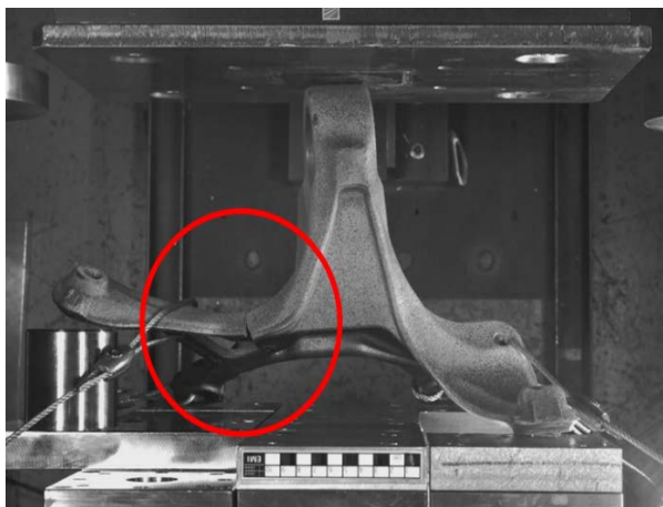
Abbildung 5-55: Versagensbild der Konsole im dynamischen Experiment (links) und im Modell (rechts) mit der berechneten Verteilung der plastischen Vergleichsdehnung aus MAT_24
