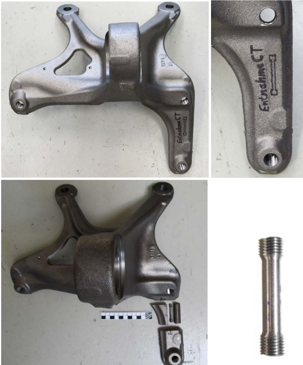
Abbildung 3-135: Entnahme einer Rundzugprobe aus Lagerkonsole zur CT-Untersuchung
