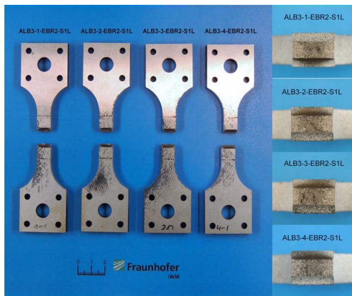
Abbildung 3-61: Ebene-Dehnungsproben nach Versuch und Bruchflächen, GJS-500-14
