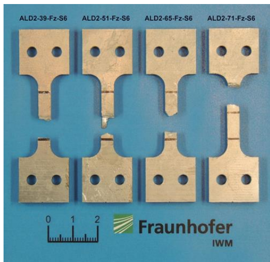
Abbildung 5-25: Mit Gusshaut geprüfte Proben aus Entnahmeposition 6
