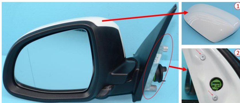
Abbildung 10: Analysiert wird der Verbau der Abdeckkappe an den Außenspiegel (Bild 1), der Verbau des Außenspiegels an das Fahrzeug und die Steckerkontaktierung (Bild 2).
