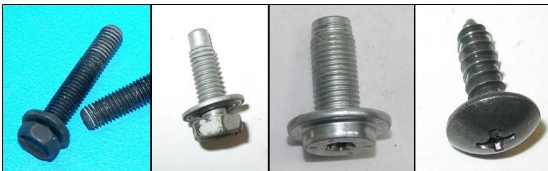
Abbildung 33: Metrische Schraube mit Anfädeln, Metrische Schraube ohne Anfädeln, MA Thread ohne Anfädeln, Blechschraube ohne Anfädeln (von links nach rechts).
