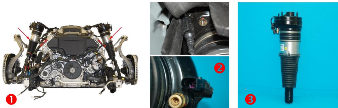
Abbildung 14: Bild 1: Verbau der Luftfederung im Fahrzeug. Bild 2: Stecker der Stoßdämpfer. Bild 3: Zerlegtiefe für die eHPV Bewertung.
