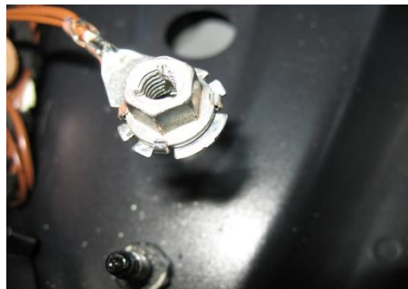
Abbildung 39: Masseverschraubung mit vormontiertem Schraubteil.
