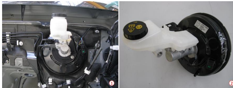
Abbildung 11: Analysiert wird der Verbau des Bremskraftverstärkers im Fahrzeug (Bild 1) und das Aufbringen und Verschrauben des Schraubverschlusses (Bild 2).
