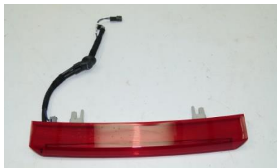
Abbildung 40: Kabelschwanz an Bremsleuchte. Die Verlegung des Kabels wird der Bremsleuchte zugeordnet.
