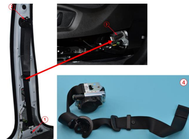
Abbildung 8: Analysiert werden Befestigungspunkte 1-3. Bild 4 zeigt die für die eHPV-Bewertung relevante Zerletiefe.
