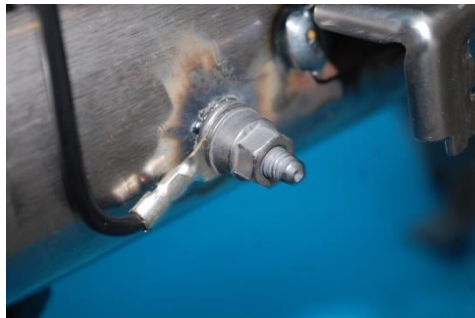
Abbildung 38: Masseverschraubung mit unlackiertem Schraubteil.
