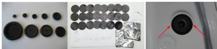
Abbildung 31: Stopfen (links), Pads (Mitte), Schmelzdeckel (rechts)
