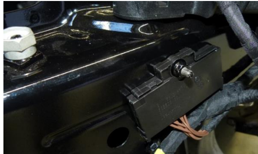
Abbildung 37: Masseverschraubung mit lackiertem Schraubteil.
