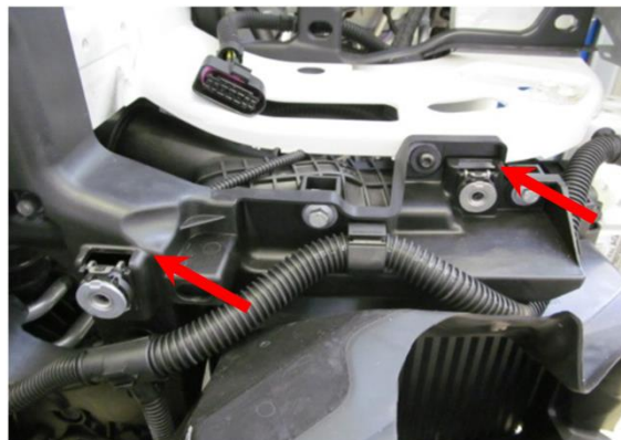
Abbildung 28: Beispiel für Einstellelemente (hier: am Scheinwerferträger).
