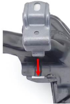
Abbildung 25: Halter nur in einer Position montierbar.
