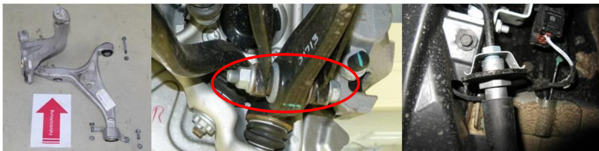
Abbildung 34: Querlenker (links und Mitte), Bremsschlauch an Leitung (rechts)
