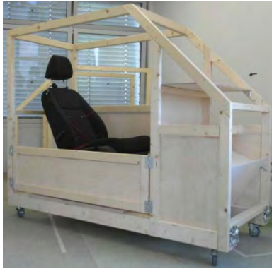
Abbildung 2: Grundgerüst des Versuchsstands mit Fahrersitz ohne eingebaute Klimatisierungstechnologien.
