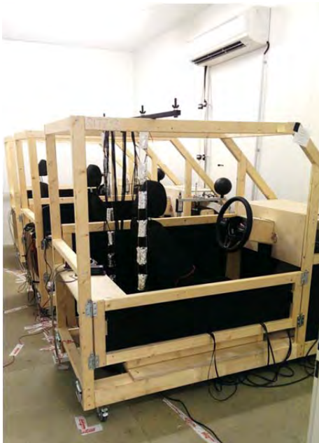
Abbildung 4: Messtechnisch vollständig ausgestattete Fahrzeugstände im Versuchscontainer.
