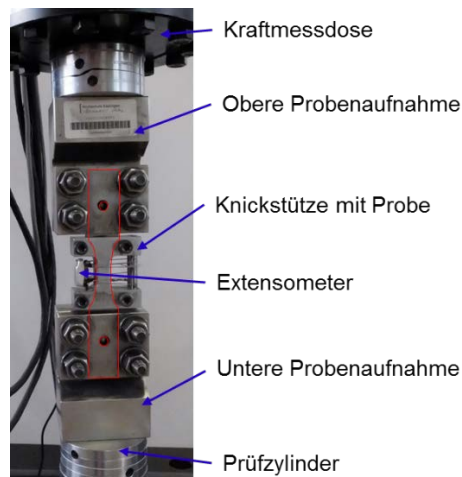
Abbildung 5.12: Versuchsaufbau der dehnungskontrollierten Schwingfestigkeitsversuche
