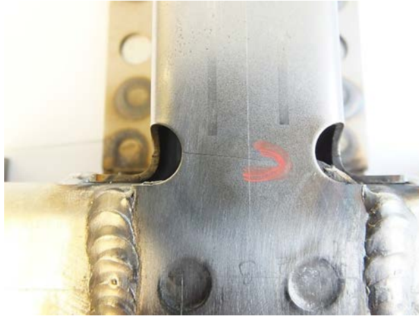
Abbildung 6.73: Anriss im Bereich des schergeschnittenen (Referenz) Freischnittes, am Beispiel DP800
