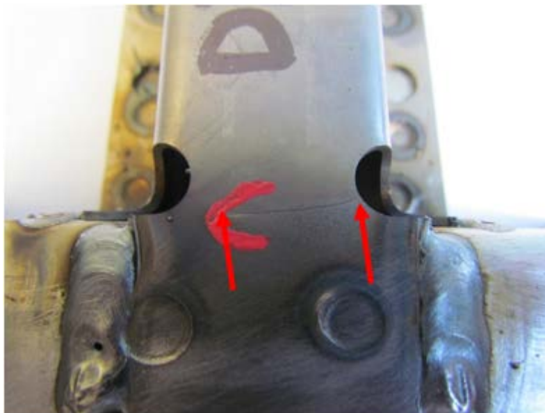
Abbildung 6.76: Anriss im Bereich des lasergeschnittenen Freischnittes, am Beispiel DP1000
