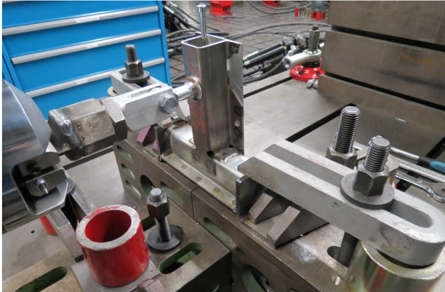
Abbildung 4.17: Einspannung der bauteilnahen Geometrie am servohydraulischen Prüfstand MTS Systems im Hause der Daimler AG, Sindelfingen
