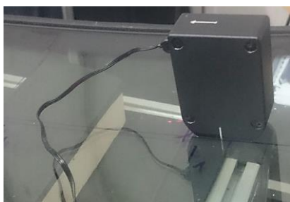
Abb. 10: Untersuchungen der Eigenspannungen einer Windschutzscheibe Mittels SCALP (links) und Darstellung der gemessenen Eigenspannungen auf einer Windschutzscheibe (rechts)
