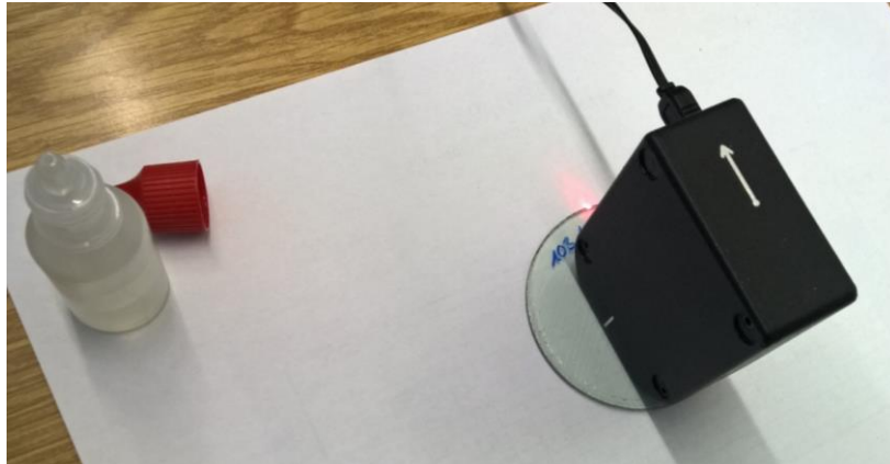
Abb. 15: Eigenspannungsmessung mittels SCALP an einem aus einer Windschutzscheibe herausgetrennten kleinen, runden Probekörper.
