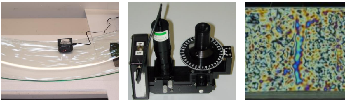
Abb. 9: links: SCALP-Messung an gebogenem Glas, mittig: Laser GASP, rechts: Polfilteraufnahme von thermisch gebogenem, vorgespanntem Glas.
