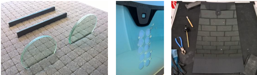
Abb. 7: Beispielhafte Probekörper aus dem mittleren Bereich der Windschutzscheibe, sowie dem Randbereich (links), Entnahmestellen aus einer Windschutzscheibe (mitte), Probekörperherstellung mittels Glasschneider an nicht laminierten Einzelscheiben (rechts)
