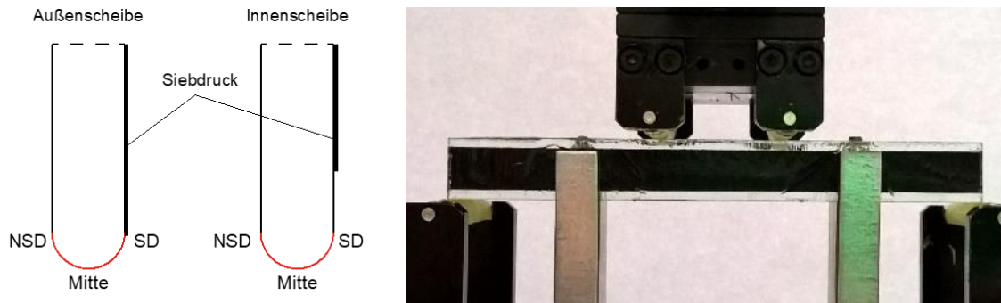
Abb. 41: links: Siebdruck an der Kante, rechts: Versuchsaufbau zur Prüfung der Kantenfestigkeit (Probekörper aus einer Innenscheibe)
