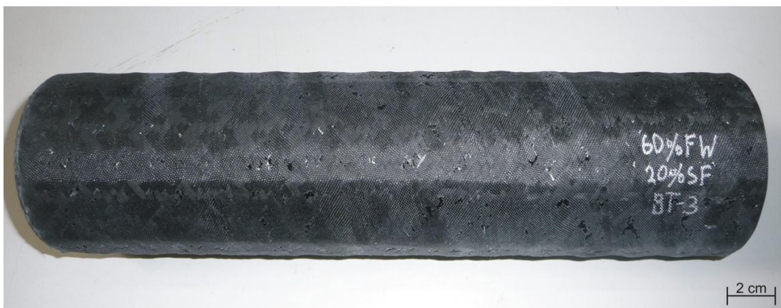
Abb. 11-14: 60° Flechtwinkel mit 20 % Stehfadenanteil, getränkt
