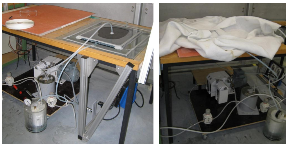
Abb. 4-29: Infusions- (links), Aushärtevorgang (rechts)
