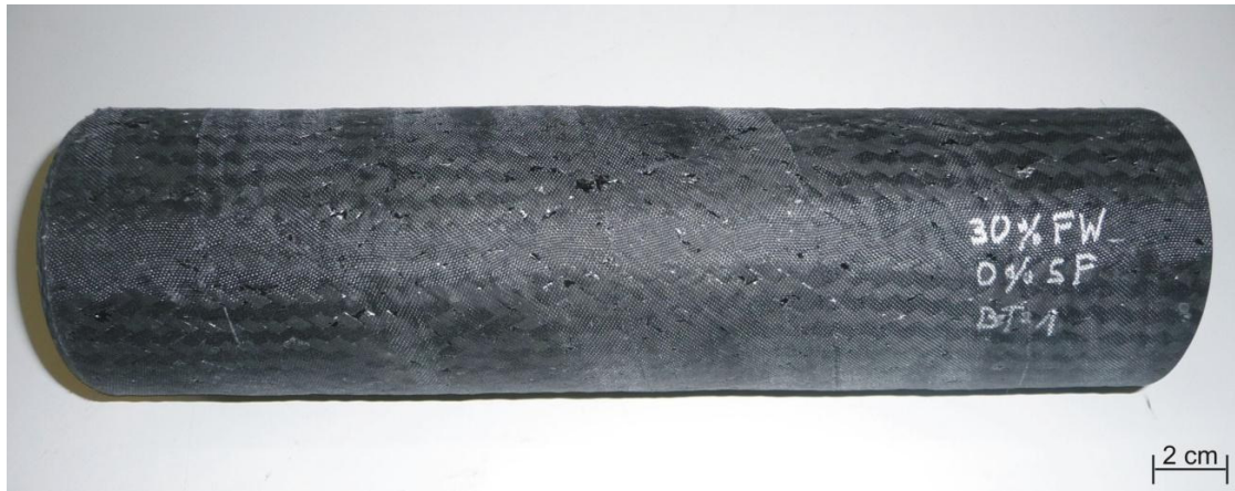
Abb. 11-7: 30° Flechtwinkel mit 0 % Stehfadenanteil, getränkt
