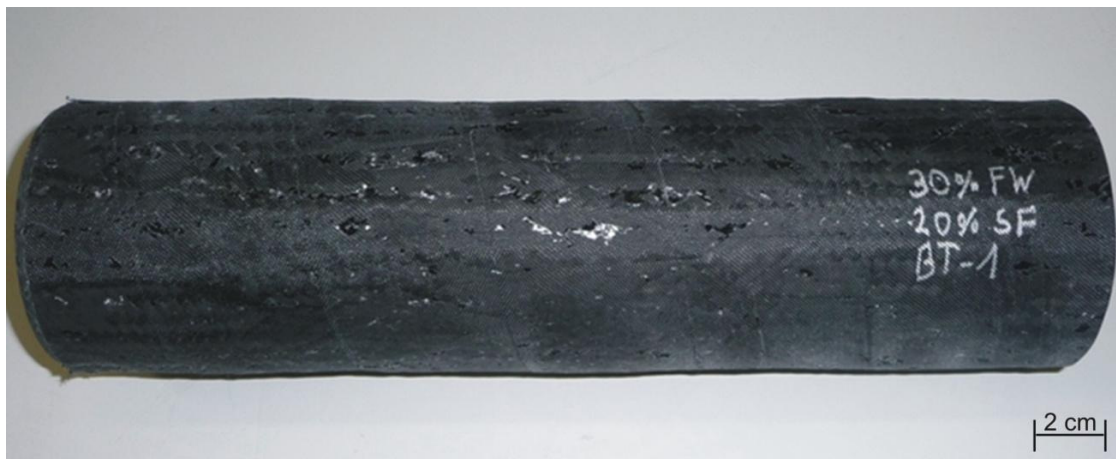
Abb. 11-8: 30° Flechtwinkel mit 20 % Stehfadenanteil, getränkt
