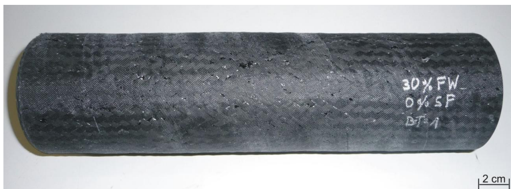
Abb. 4-22: Getränktes Rohr mit 30° Flechtwinkel und 0 % Stehfadenanteil
