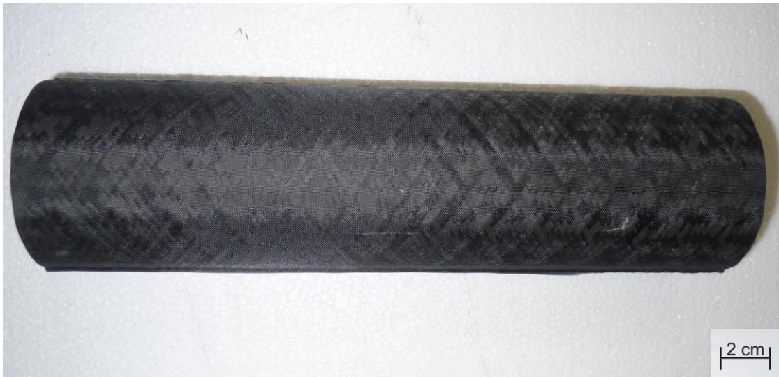
Abb. 11-13: 60° Flechtwinkel mit 0 % Stehfadenanteil, getränkt
