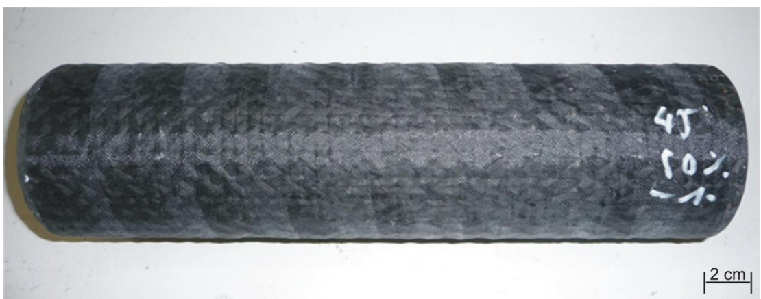
Abb. 11-12: 45° Flechtwinkel mit 50 % Stehfadenanteil, getränkt
