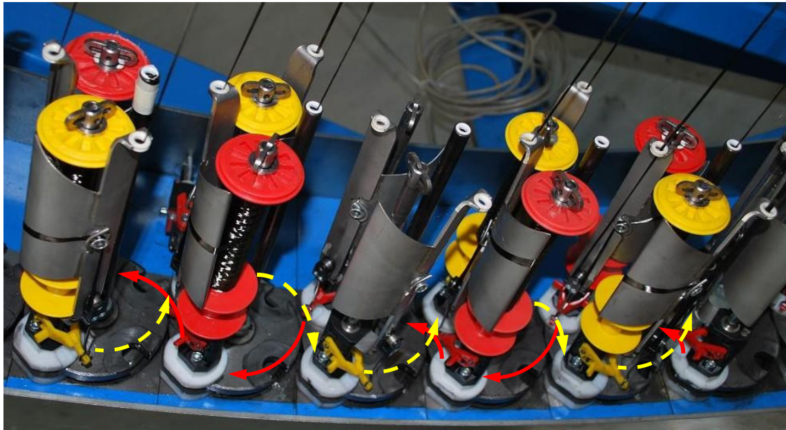
Abb. 4-3: Bewegungsbahnen der Klöppel
