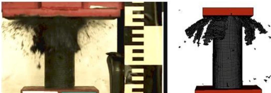
Abb. 6-49: Vergleich Realversuch und Simulation nach 100 mm Deformationsweg
