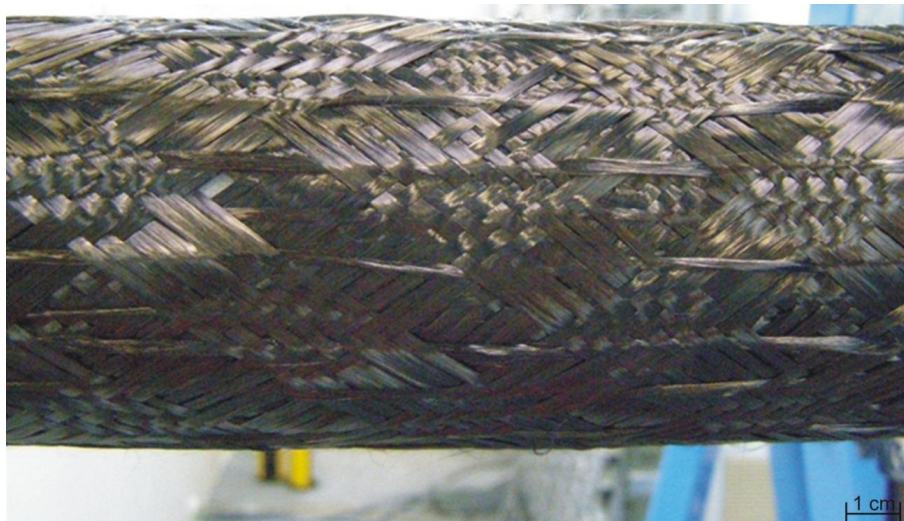
Abb. 11-2: 45° Flechtwinkel mit 20 % Stehfadenanteil
