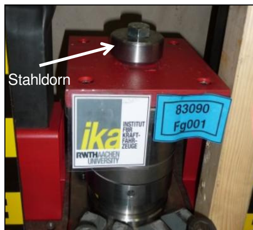
Abb. 5-9: An der Fallturmbasis angeschraubter Stahldorn
