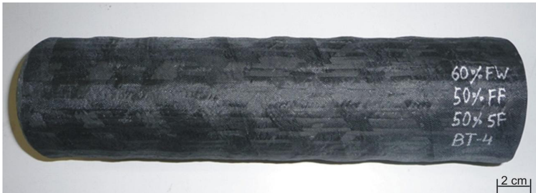
Abb. 4-23: Getränktes Rohr mit 60° Flechtwinkel und 50% Stehfadenanteil
