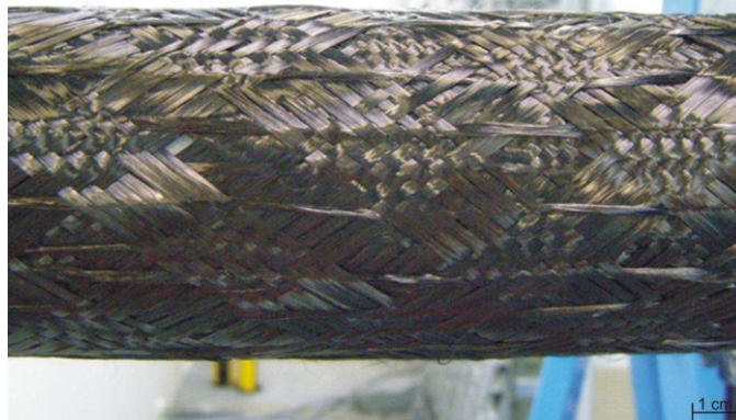
Abb. 4-20: 45° Flechtwinkel mit 20 % Stehfadenanteil
