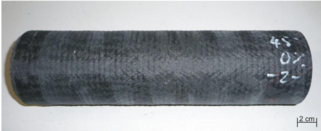
Abb. 11-10: 45° Flechtwinkel mit 0 % Stehfadenanteil, getränkt
