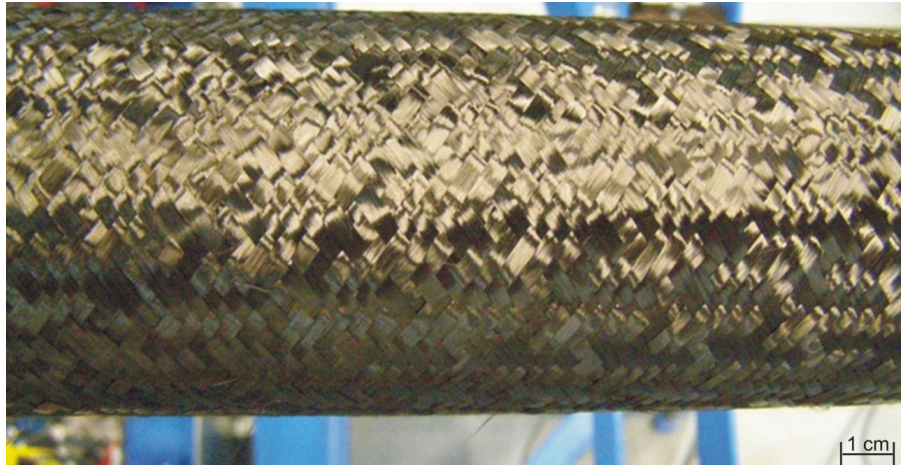
Abb. 11-4: 60° Flechtwinkel mit 0 % Stehfadenanteil
