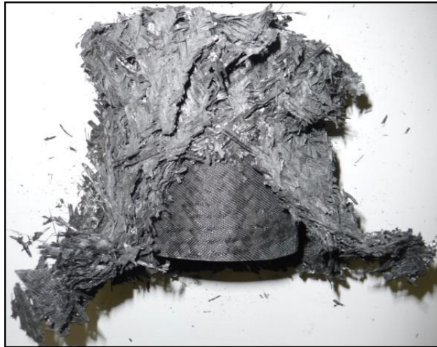
Abb. 5-13: Im Fallturmversuch getestete Rohrprobe
