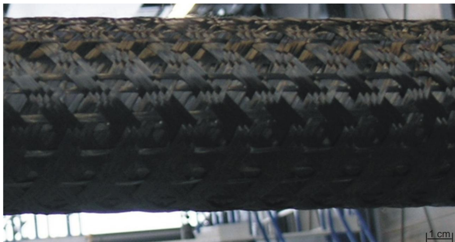
Abb. 11-5: 60° Flechtwinkel mit 20 % Stehfadenanteil
