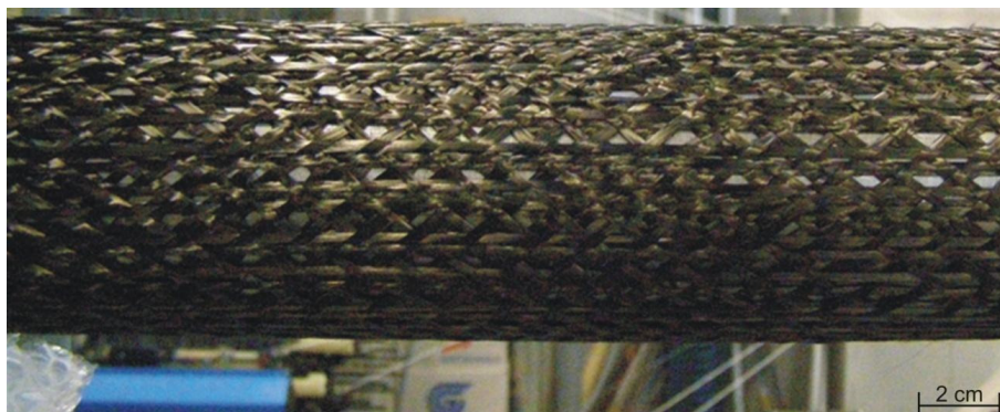
Abb. 11-3: 45° Flechtwinkel mit 50 % Stehfadenanteil
