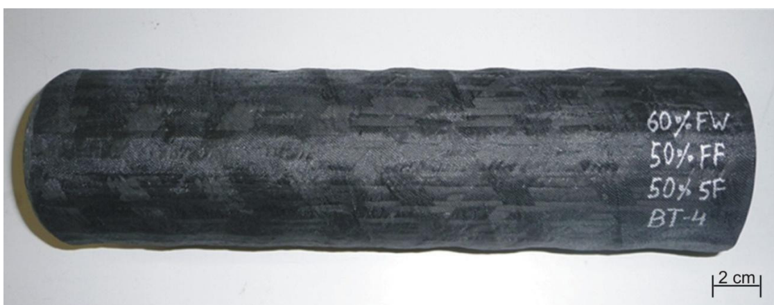
Abb. 11-15: 60° Flechtwinkel mit 50 % Stehfadenanteil, getränkt
