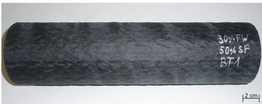
Abb. 11-9: 30° Flechtwinkel mit 50 % Stehfadenanteil, getränkt
