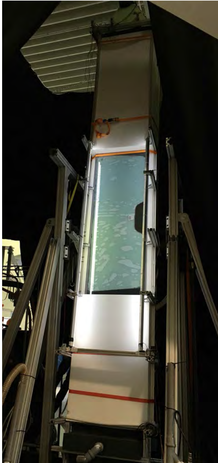
Abbildung 34: Foto des Versuchsträgers Spaltwindkanal am Deutschen Zentrum für Luft- und Raumfahrt in Göttingen mit der realen Fahrzeugscheibe (Frontscheibe Mercedes G-Klasse).
