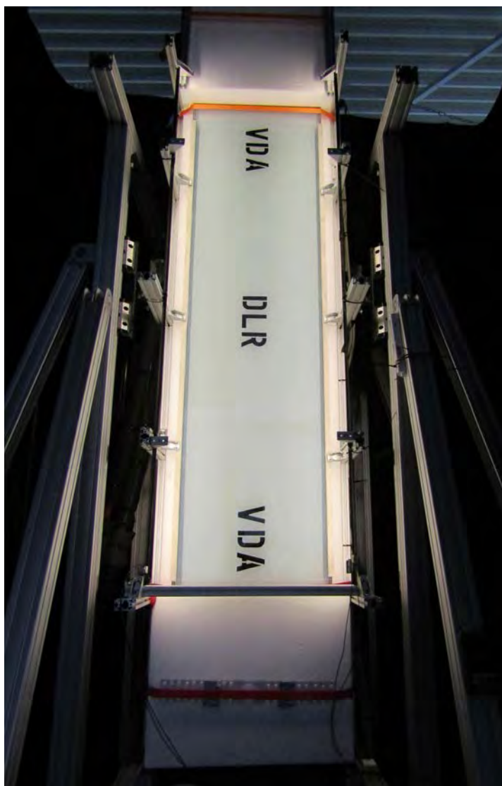
Abbildung 33: Foto des Versuchsträgers Spaltwindkanal am Deutschen Zentrum für Luft- und Raumfahrt in Göttingen mit einer Glasscheibe.
