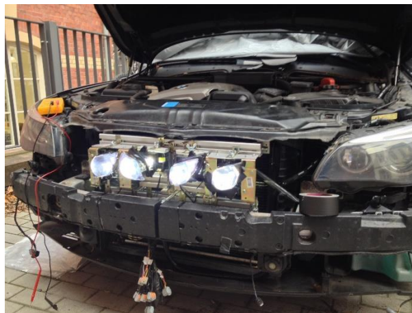
Abbildung 6-3: Befestigung LED-Module am Fahrzeug
