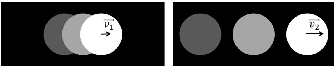
Abbildung 2-1: Stroboskopeffekt bei langsamer (links) und schneller (rechts) Objektbewegung
