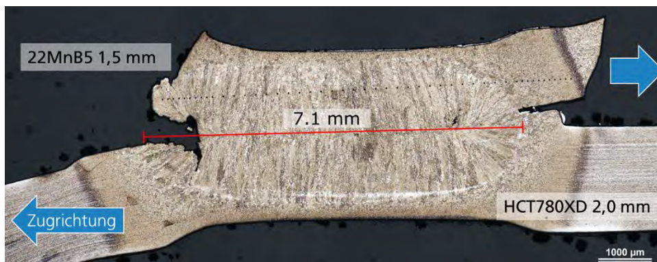
Bild 11 Schliff der gebrochenen Probe 1a-8-Sz-2 der Verbindung mit 22MnB5 (1,5 mm) und HCT780XD (2,0 mm) mit d_L = 7,1 \text{ mm}
