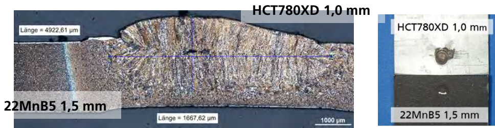
Bild 7 Bruch entlang der Schweißlinsengrenze in Versuchsreihe 1a-1 22MnB5 (1,5 mm) – HCT780XD (1,0 mm) mit d_L = 4,5 \text{ mm}
