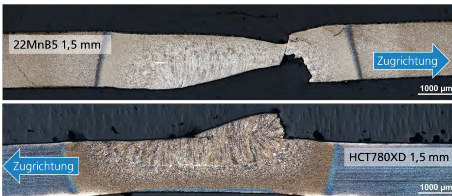
Bild 9 Schliff der gebrochenen Probe 1a-4-Sz-3 der Verbindung 22MnB5 ( t = 1,5 mm) und HCT780XD ( t = 1,5 mm) mit d_L = 4,7 mm
