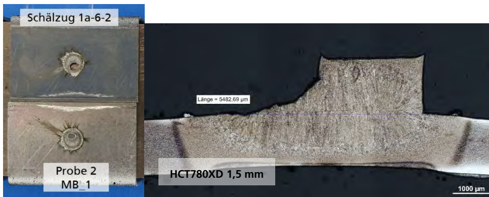
Bild 38 Bildaufnahme nach Bruch und Schliff der Probe 1a-6-Sa-2 der Verbindung mit 22MnB5 (1,5 mm) und HCT780XD (1,5 mm) mit d_L = 5,5 \text{ mm}
